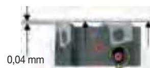
Achtung: Auf korrekte Position der Schneidplatte im Plattensitz achten
