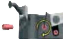
Achtung: Auf korrekte Position des Schneidkörpers im Plattensitz achten!
